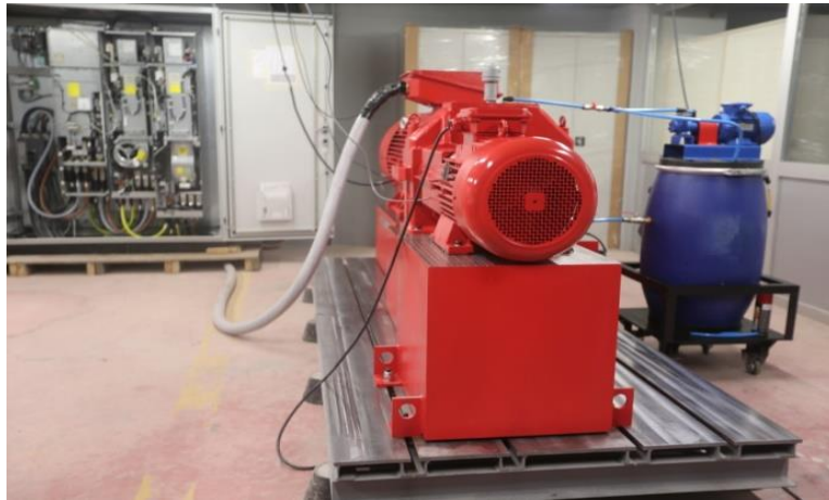
Elektrikli Motor Test Bankosu
